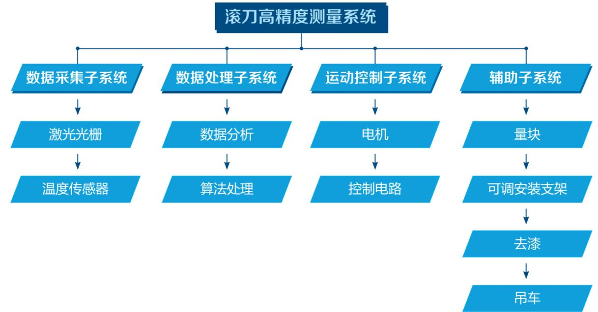
整个系统由激光光栅数据采集子系统、数据处理子系统、运动控制子系统、机械支撑辅助子系统等四部分组成。
