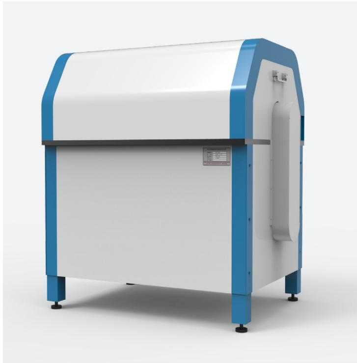
玖瑞科技与北京工业大学联合研制的滚刀高精度测量及圆度评价系统，弥补了以往难以精确获得刀具磨损量的不足，可以高精度测量滚刀刀具磨损量及评价圆度，为盾构与TBM刀具设计与选型提供依据，是玖瑞科技测控技术在岩土与地下工程领域的典型应用。
