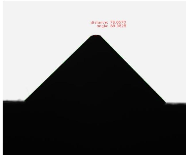
图 2.2 典型针尖侧面智能测量图
