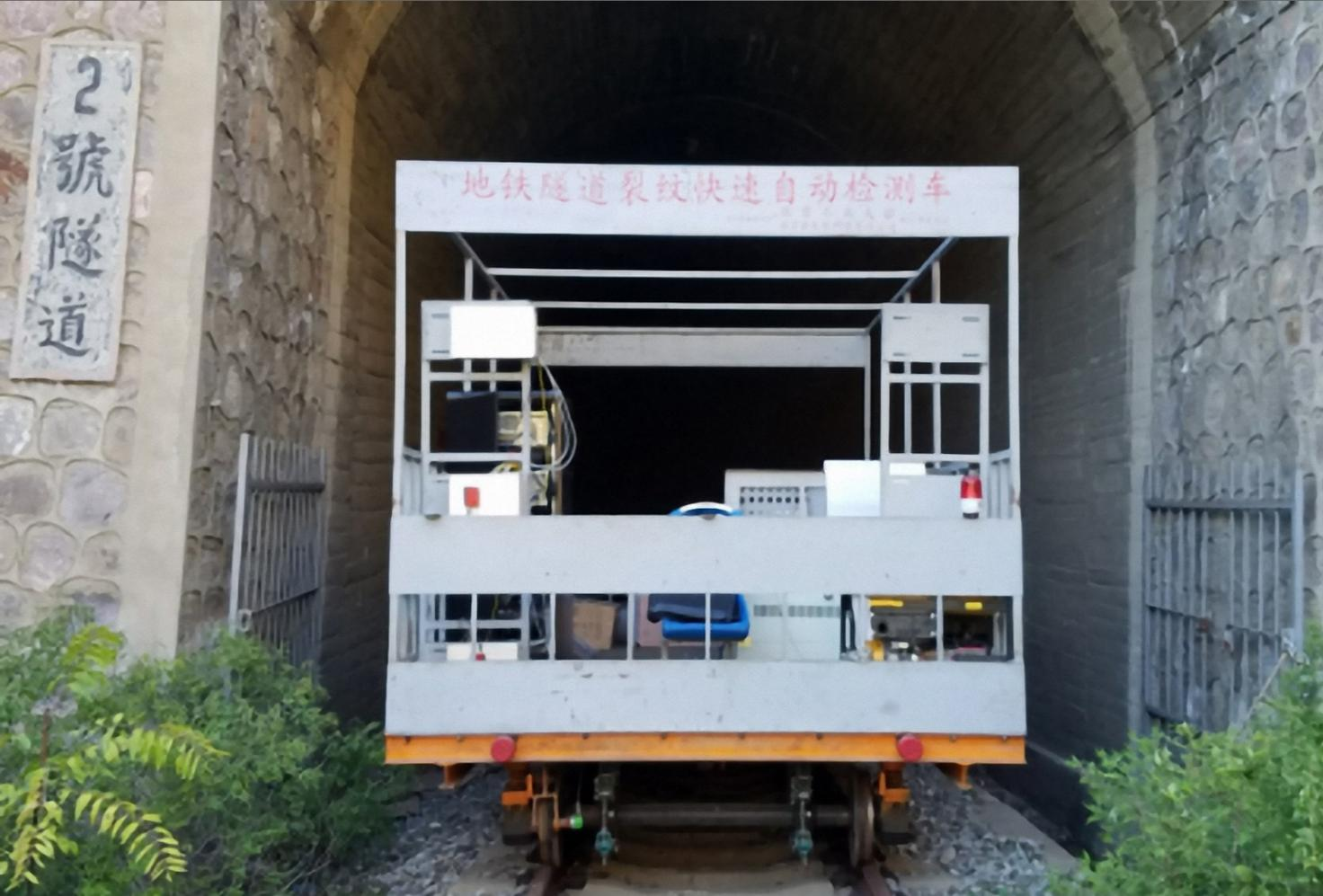
玖瑞科技与北京工业大学联合研制的地铁隧道表面缺陷检测系统，可快速智能检测隧道表面裂纹、漏水及形变，是机器视觉与人工智能技术在岩土与地下工程领域的典型成功应用。
