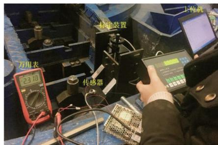
图15 磨损量传感器标定
