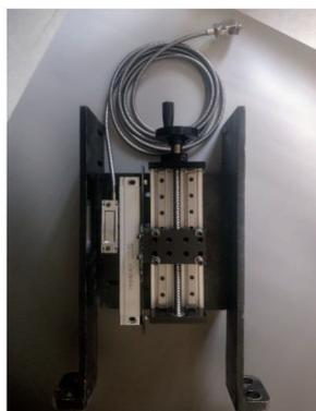
图13 安装于刀盘上的标定装置
